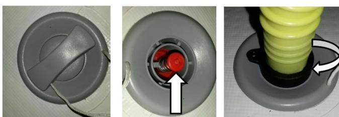
K vyfúknutiu stlačte bezpečnostný čap (čapom netreba otáčať). Uistite sa, že sa čap nachádza v "DOWN" pozícii. Okolie ventilu pred vypúštaním očistite od piesku či drobných nečistôt, ktoré by sa mohli vypúštaným vzduchom zvŕať.
